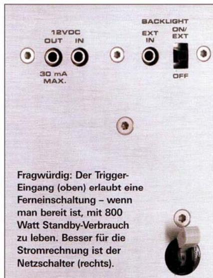
Fragwürdig: Der Trigger-Eingang (oben) erlaubt eine Ferneinschaltung – wenn man bereit ist, mit 800 Watt Standby-Verbrauch zu leben. Besser für die Stromrechnung ist der Netzschalter (rechts).
